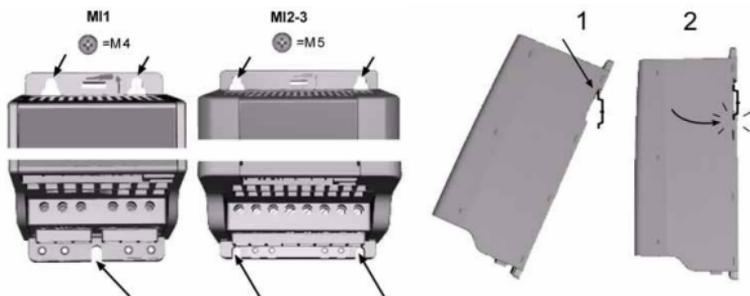
Рисунок 1: Монтаж с использованием винтов (слева) и DIN-рейки (справа)
