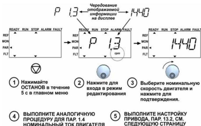
Рисунок 2: Мастер запуска привода Vacon 10 (для приложения общего применения)
